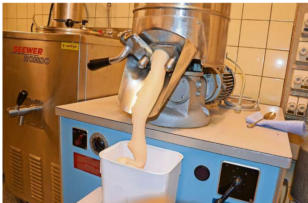
Die Glacémaschine rührt die gekühlte Eismasse, bis sie als fertiges Glacé aus der Maschine läuft.
